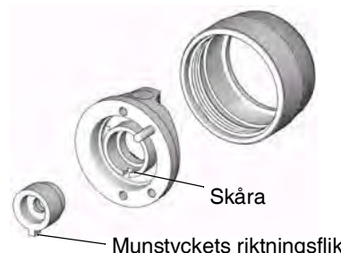
Fig. 7: Inställning av sprutmunstycke och luftmunstycke
